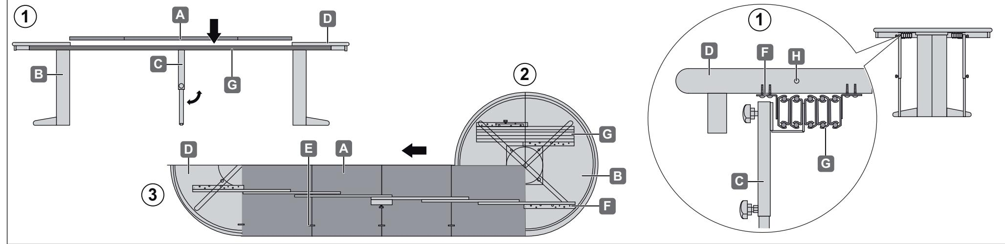
**de** Führungsstifte und Hülsen (H) an den Tischplattenhälften (D) und Einlagen (A) anbringen, sowie zur Arretierung Spannverschlüsse (E) an der Unterseite anschrauben.
