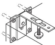
Einbau-Klappbetten müssen nach EN 1129 grundsätzlich gegen Kippen gesichert werden. Sicherungsbeschlag bitte separat bestellen. Sicherstellen, dass der Untergrund für die Befestigung der Sicherungsbeschläge geeignet ist.
